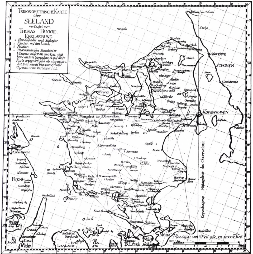
Reproduktion af Bugges trigonometriske kort fra den tyske udgave af bogen. Det for en del utydelige kvadratnet med siden 1 mil eller 12000 alen og rettet efter hovedbasislinien havde været udstukket i terrainet til brug for den topografiske opmåling.
